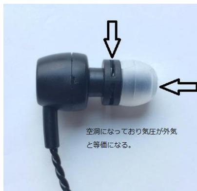
イヤピースを装着しても外耳道と外部の気圧が同じなので圧迫感がない。
